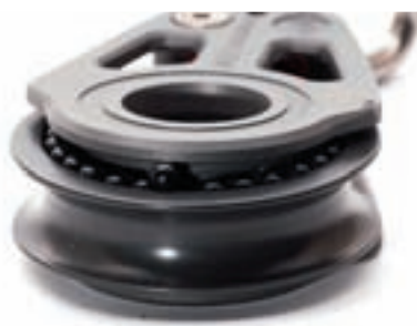
Unter hohen Lasten öffneten sich oft die Wangen der Blöcke, hier Lewmar Racing
