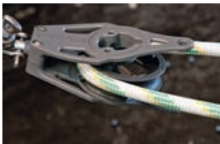
Eine fehlende Schraube sorgte für das frühe Versagen des Lewmar Synchro
