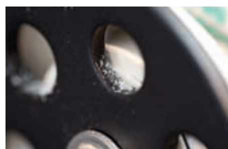
Wenn Scheiben unter Last verkanten, sorgt das für frühen Verschleiß (OH)
