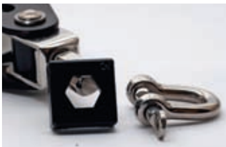
Die Arretierung der Wirbel, hier OH, ist oft abnehmbar und kann verloren gehen
