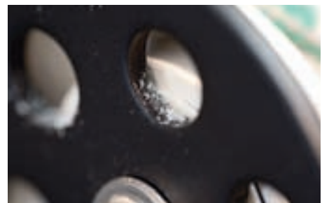
Wenn Scheiben unter Last verkannten, sorgt das für frühen Verschleiß (OH)
