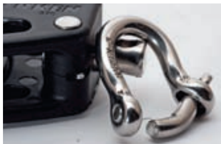
Die Schäkel der Harkenblöcke sind so ausgelegt, dass sie zuerst zerreißen
